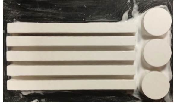
Рис. 3. Напечатанные образцы методом 3D DLP печати
