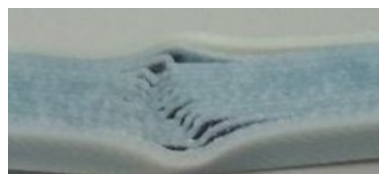
Рис. 7. Характерное разрушение образцов групп 1 и 2 с плоским армированием XY и XZ – межслойный сдвиг (расслоение образца)
