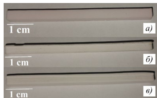
Рис. 6. Образцы в виде балок, полученные при спекании по экспериментальным режимам: а – Режим № 1; б – Режим № 2; в – Режим № 3
