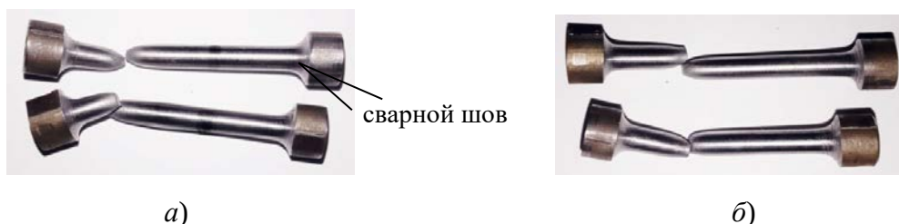
Рис. 5. Внешний вид образцов после разрушения. Расположение шва: a – поперечное; б – продольное
