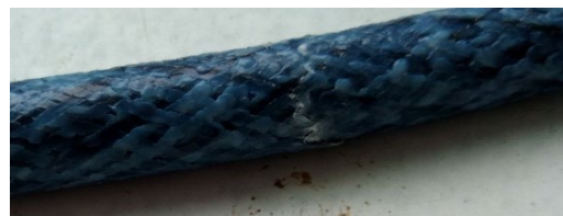
Рис. 8. Характерное разрушение образцов групп 4 – 6 в виде брусков и группы 7 в виде цилиндров с сетчатым цилиндрическим армированием – растяжение
