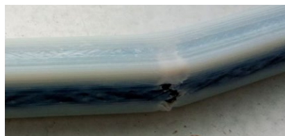
Рис. 8. Характерное разрушение образцов групп 4 – 6 в виде брусков и группы 7 в виде цилиндров с сетчатым цилиндрическим армированием – растяжение
