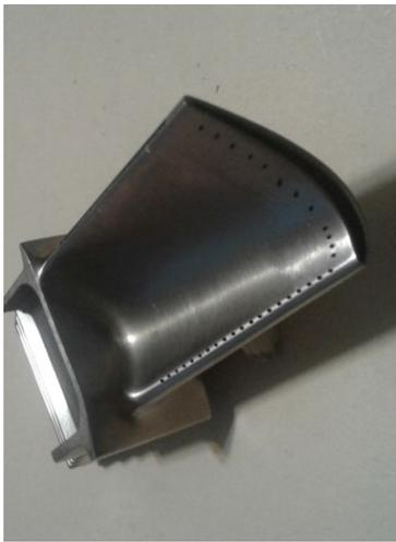
Рис. 5. Охлаждаемая металлическая лопатка с продольными и радиальными каналами
