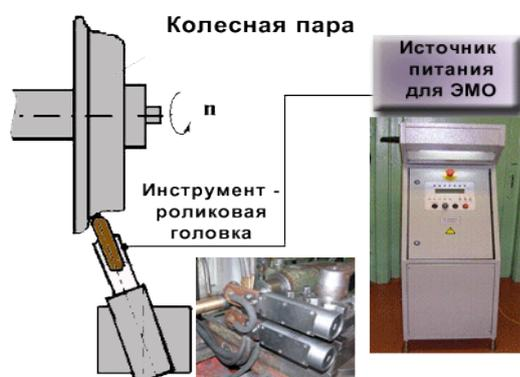
Рис. 9. Схема обработки железнодорожных колес
