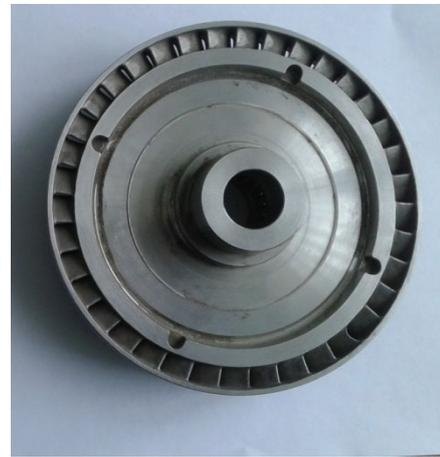
Рис. 4. Рабочий диск турбонасосного агрегата
