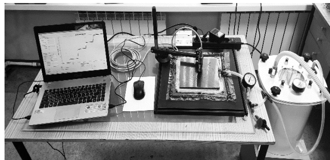
Рис. 6. Общий вид установки для измерения сжимаемости композитных преформ
