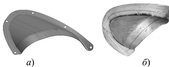
Рис. 3. CAD модель тонкостенного обтекателя (а) из ПКМ и открытая металлическая форма (б) для его формования
