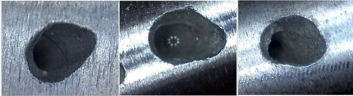
Рис. 5. Геометрия и вид фактического скругления кромок отверстий лопаток турбин, обработанных электроэрозионным фрезерованием по программе фирмы Winbro Group
