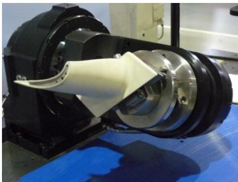
Рис. 3. Общий вид установки и разворота рабочей лопатки турбины в многоосевом поворотном приспособлении
