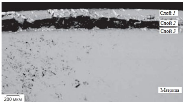
Рис. 3. Структура поверхности стального образца, упрочненного карбидом вольфрама, \times 100
