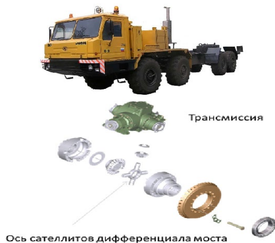
Рис. 6. Применение технологии ИКЭМО для повышения износостойкости узла трения «сателлит – ось сателлита»
