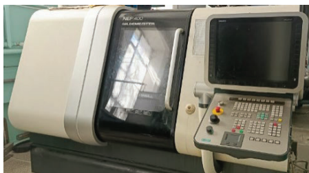
Рис. 2. Токарный обрабатывающий центр DMG NEF400
