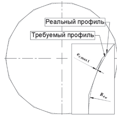
Рис. 1. Огранка, формируемая в процессе ортогональной токарно-фрезерной обработки
