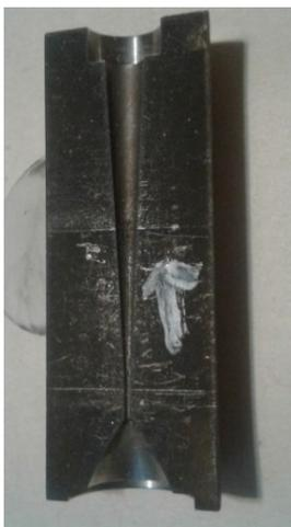
Рис. 3. Образец из жаропрочного материала, имеющий профиль отверстия с переменным сечением
