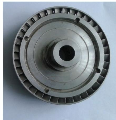
Рис.4. Рабочий диск турбонасосного агрегата
