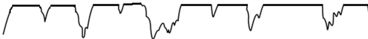
Рис. 2. Профилограмма профиля шероховатости после приработки поверхности трения
