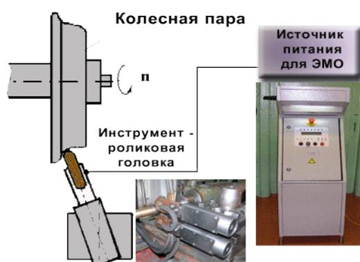
Рис. 9. Схема обработки железнодорожных колес
