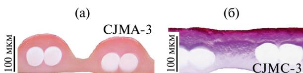
**Рис. 3.** Оптические изображения срезов анионообменной мембраны СЈМА-3 (а) и катионообменной мембраны СЈМС-3 (б) после их участия в ЭД тартратной стабилизации модельного виноматериала в режиме НЭП. Верхняя сторона мембран была обращена в камеру обессоливания, через которую прокачивался модельный виноматериал.
