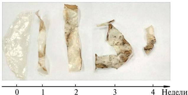
Рис. 5. Изменение внешнего вида пленок под воздействием микромицета *Aspergillus niger* с течением времени.
