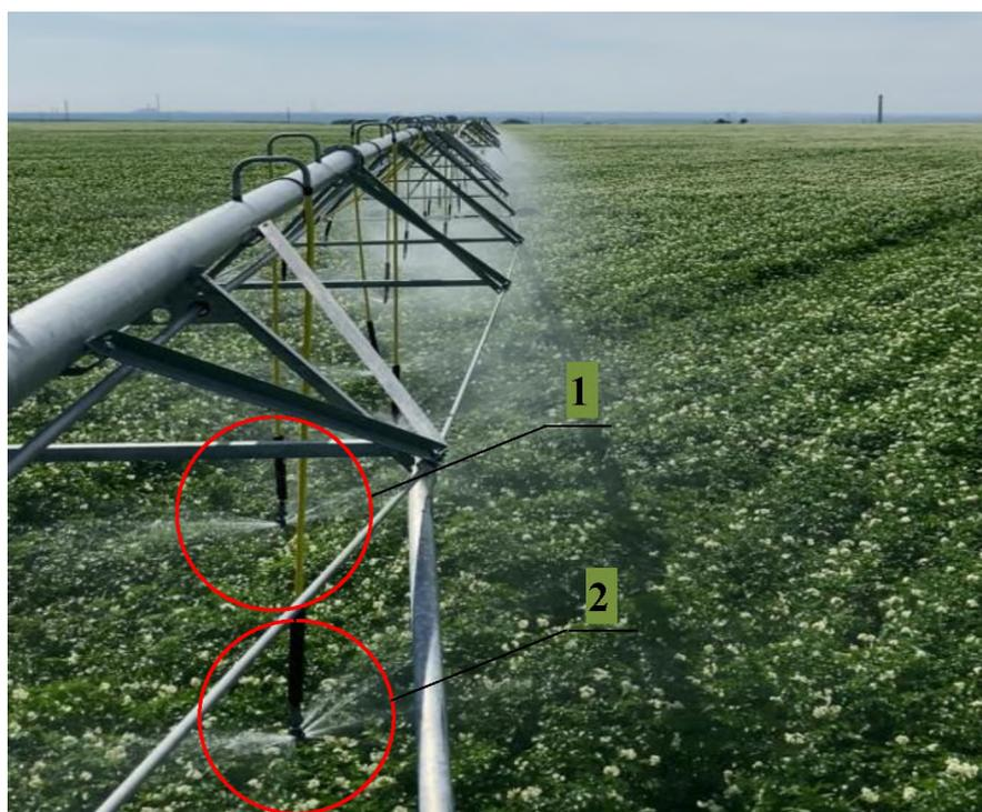
Рисунок. Фрагмент зон смачивания дождевателями широкозахватной круговой дождевальной машине фирмы T-L Irrigation company
