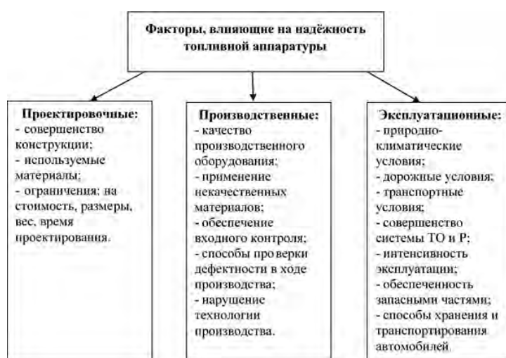
Рисунок 1. Факторы, влияющие на надёжность системы питания автомобильных дизельных двигателей Источник: разработано авторами
