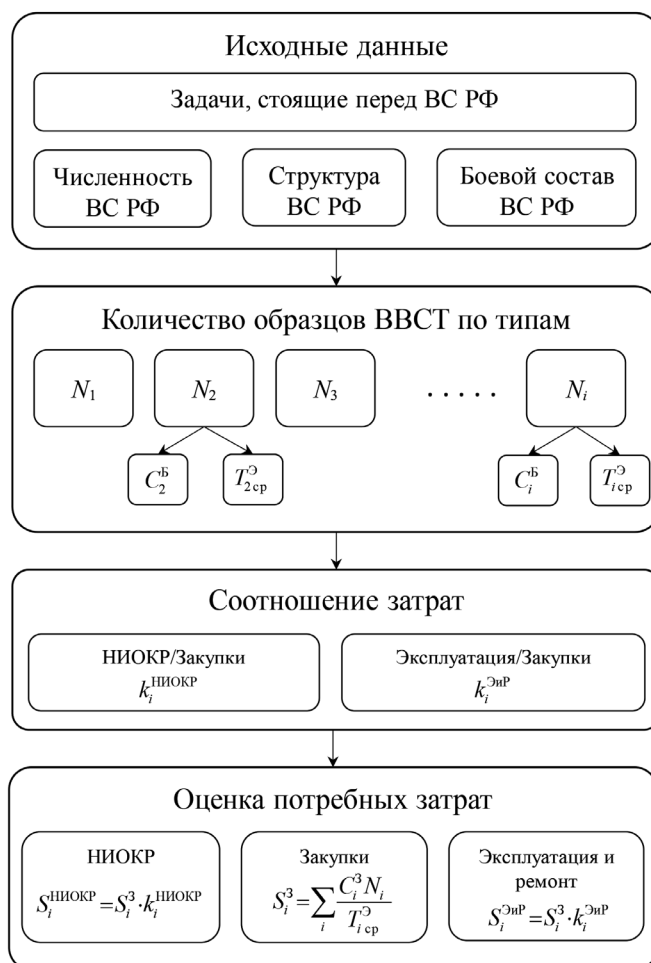
Рис. Порядок расчета потребных затрат на НИОКР, закупки, эксплуатацию и ремонт ВВСТ
