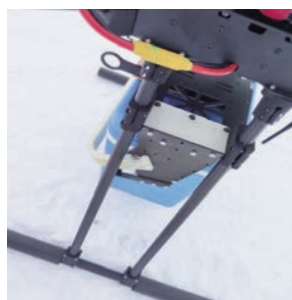
Рис. 2. Система крепления контейнера для перевозки компонентов крови на БПЛА Fig. 2. System of fixing the container for transportation of blood components on the UAV
