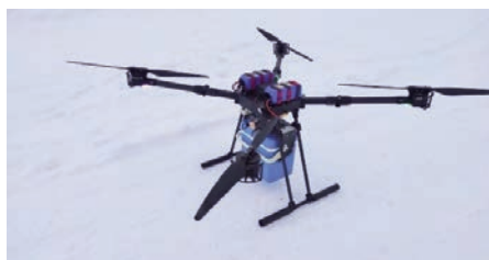
Рис. 1. Беспилотный летательный аппарат (БПЛА) с зафиксированным контейнером для перевозки компонентов крови Fig. 1. Unmanned aerial vehicle (UAV) with fixed container for transportation of blood components
