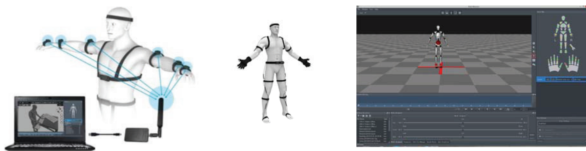
Рис. 2. Схема размещения датчиков и пример работы системы Perception Neuron 8,9
