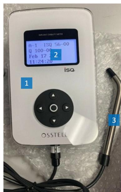
Рис. 2. Резонансно-частотный анализатор Osstell mentor
