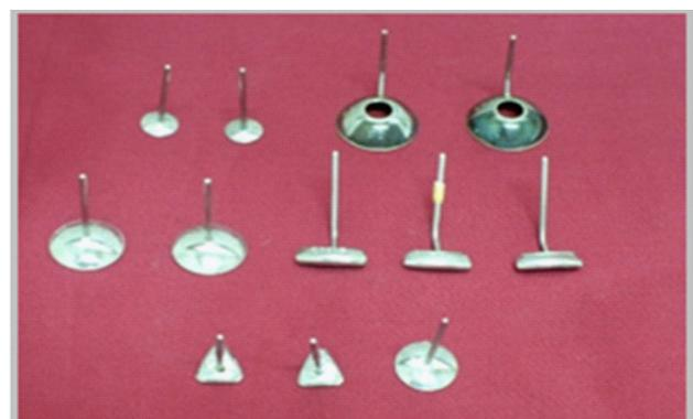
Рис. 5. Фото радиоактивных офтальмоаппликаторов с радионуклидами стронций-90 и иттрий-90
