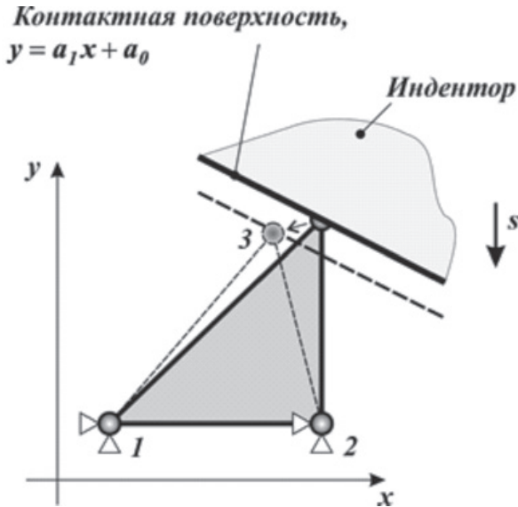
Рис. 5. Деформирование элемента под действием индентора
