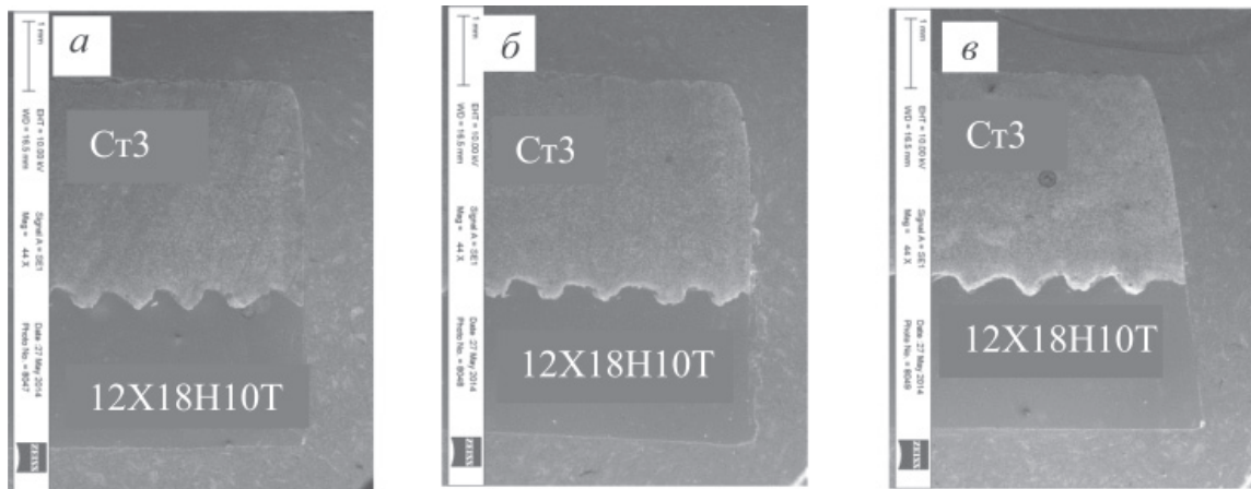
Рис. 16. Геометрия реза биметаллической композиции «сталь Ст3 + сталь 12X18H10Т» при раскросе со стороны стали Ст3 по технологической схеме Ni – Focus plus для углеродистых сталей:
