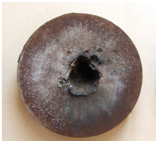
Рис. 3. Общий вид образца после взрывного нагружения по схеме, изображенной на рис. 1, б
