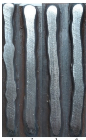
Рис. 5. Оценка качества сварного шва после механической обработки после каждого прохода
