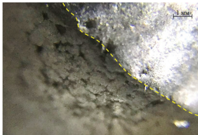
Рис. 2. Сечение границы поверхности участка износа зуба с поверхностью зуба до износа: слева – исход- ная поверхность; справа – поверхность в резуль- тате износа
