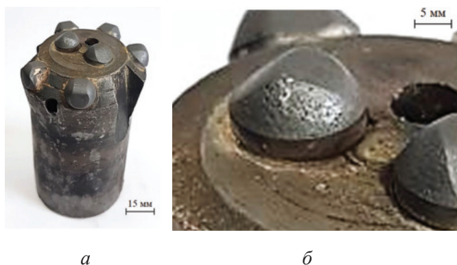
Рис. 1. Семишарошечное долото типа КНШ 40×25 производства НПО после эксплуатационных ис- пытаний при бурении гранитной породы, глубина бурения 18 см (а); состояние поверхностей зубьев коронки, характеризующееся пористостью с углуб- лениями, известными как образование поверхности «кожи рептилии» (б)
