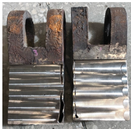
Рис. 5. Протяженные сквозные дефекты бил № 1, 3 (см. рис. 3)
