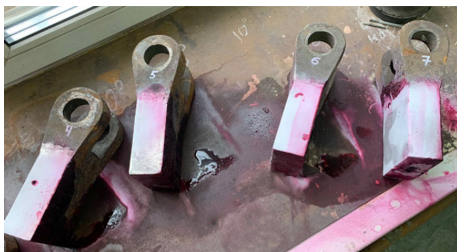
Рис. 4. Капиллярный метод контроля
