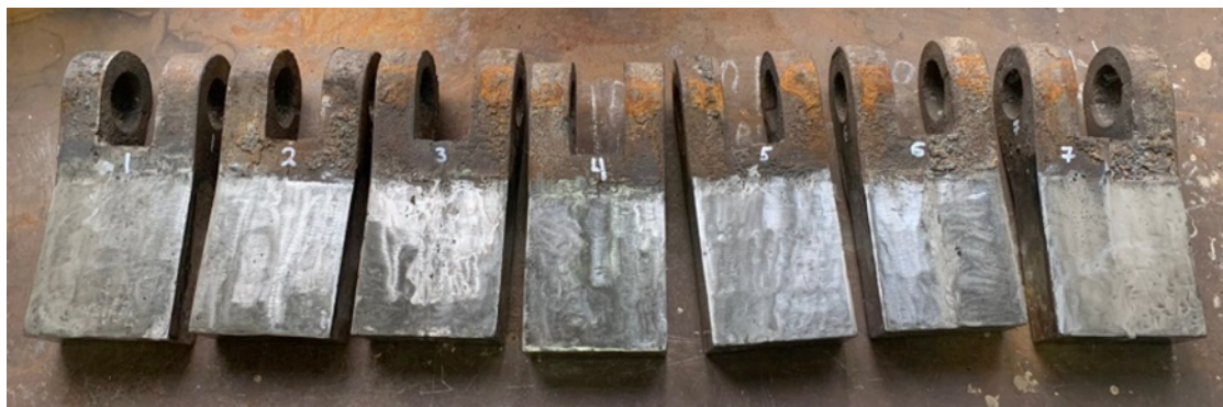
Рис. 3. Визуальный контроль поверхности бил после зачистки от металлургических шлаков
