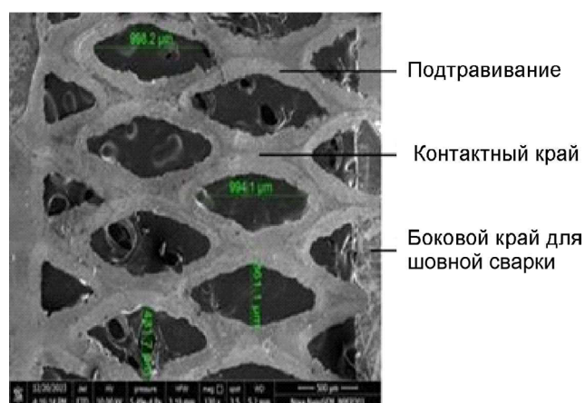
Рис. 9. Микроструктура трубчатой сетки стента: вертикальные и продольные балки в трубчатой сетке Fig. 9. Observation of vertical and longitudinal stent struts in tubular mesh
