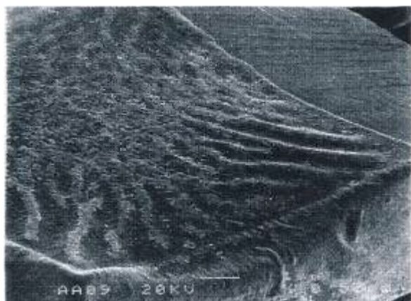
Рис. 16. Дефекты токопроводного покрытия: а – отслоения и разрывы; б – деформации [102]
