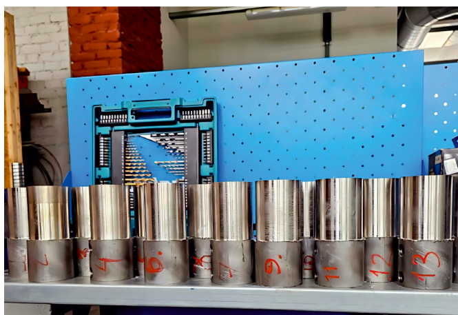
Рис. 4. Обработанные в ходе эксперимента сменные втулки
