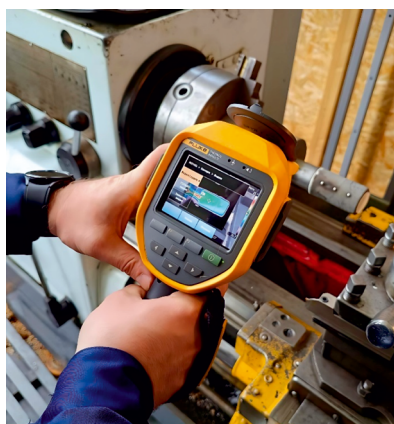
Рис. 7. Верификация показаний температуры, получаемых с термопар по тепловизору FLUKE Ti400:
