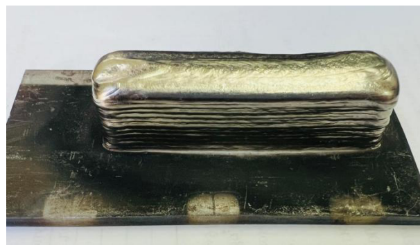
Рис. 1. Фотография заготовки (в форме стенки) стали ЕВАМ 12Х18Н10Т
