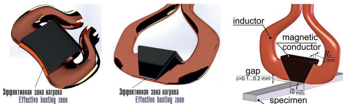
Рис. 6. Эффективная зона нагрева у индукторов различной конструкции при поверхностной закалке ТВЧ
