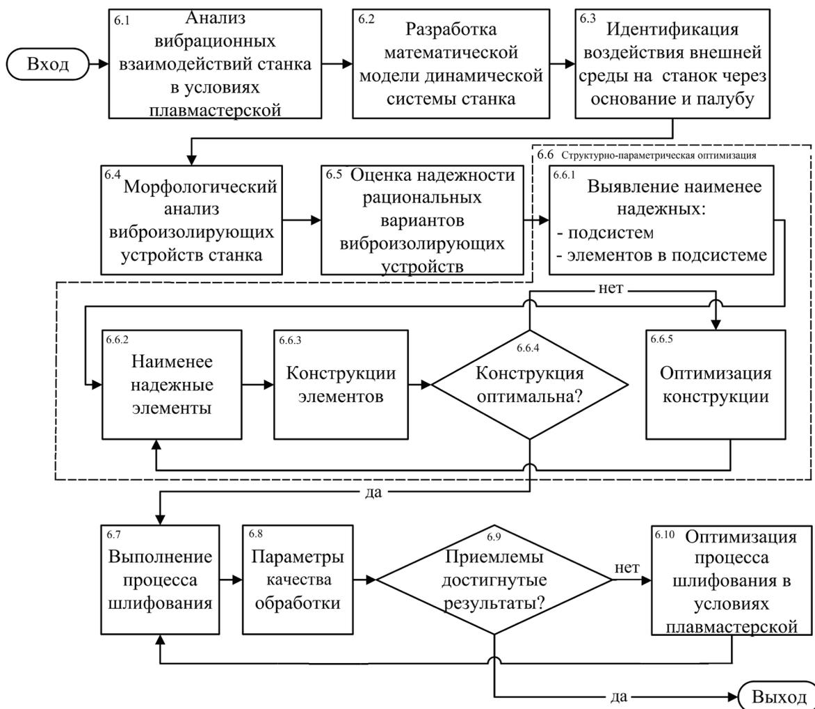
Рис. 2. Алгоритм повышения качества процесса шлифования
