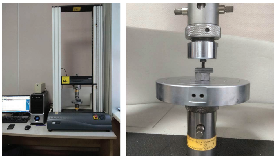
Рис. 2. Испытание прочности резьбового соединения (испытательная машина 3369 Instron)
