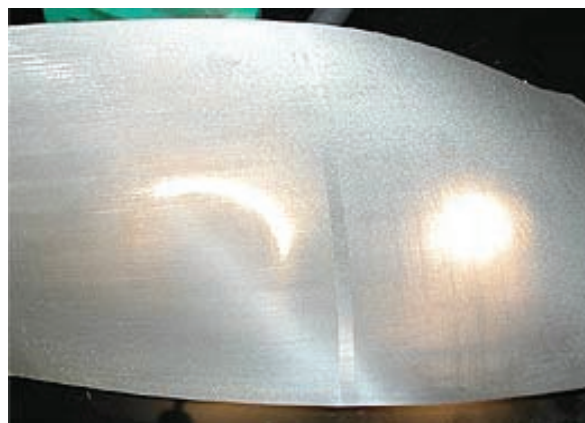
Рис. 2. Микросетка, полученная ДР из титанового листа VT1-00, толщиной 0,3 мм. Размер ячейки 20 \times 40 мкм
