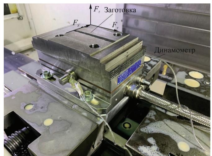
Рис. 1. Заготовка на динамометре
