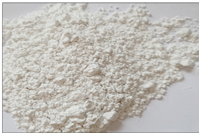
Рис. 1. Общий вид частиц карбоната кальция, используемых в качестве пенообразователя
