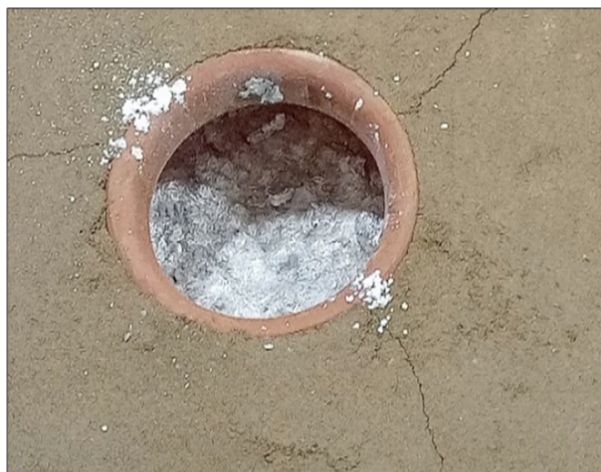
Рис. 5. Затвердевшая алюминиевая пена
