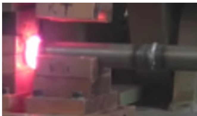
Рис. 1. Сварка труб на установке МСО-201Н
