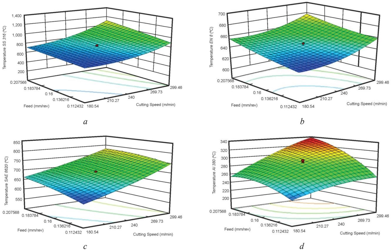
Fig. 6. Cutting temperature 3D-plots for SS 316 (a), EN 8 (b), SAE 8620 (c) and Al 380 (d)
