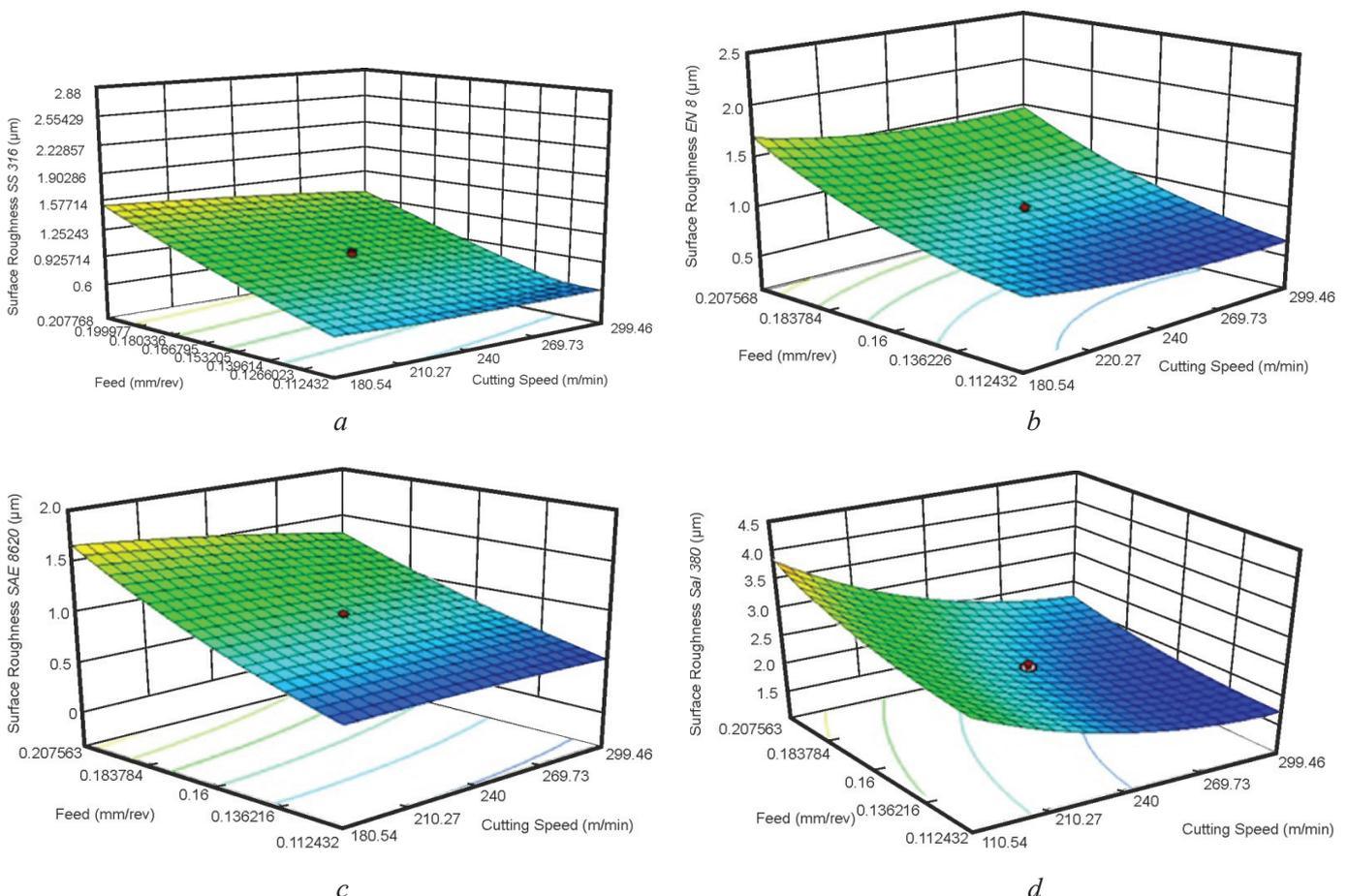
Fig. 2. Surface roughness 3D-plots for SS 316 (a), EN 8 (b), SAE 8620 (c) and Al 380 (d)
