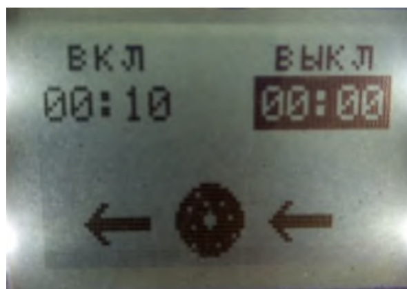
Рис. 9. Показания дисплея блока индикации: а – показания дисплея для тока прямой полярности; б – показания дисплея для тока обратной полярности
