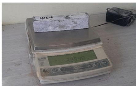
Рис. 3. Взвешивание образца-призмы геополимеров, подготовленного к испытанию на растяжение при изгибе
