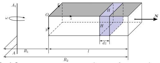
Рис. 1. Схема растяжения призматического образца от действия центробежной силы  ${m N}$  при вращении с угловой скоростью  $\omega$
