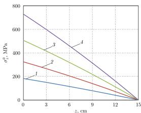
Рис. 3. Распределение осевого напряжения  $\sigma_z^0$  в сечениях образца при различной скорости вращений  $\omega$ : I-1500 об/мин; 2-2000 об/мин; 3-2500 об/мин; 4-3000 об/мин
