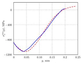
Рис. 2. Экспериментальная (сплошная линия) и расчетная (штриховая линия) эпюры остаточных напряжений в поверхностном слое призматического образца (сплав  $Э\Pi742$ ) после ультразвукового упрочнения
