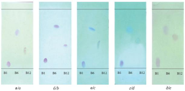
Рис. 3. Влияние соотношения  $\mathrm{CH_3CN} - \mathrm{H_2O}$  в ПФ на хроматографические характеристики витаминов. НФ: Сорбфил (ПП), ВТСХ.  $\mathrm{C_R} = 1\cdot10^{-3}$  мг/мл.  $\mathrm{B_1}$  – тиамин,  $\mathrm{B_6}$  – пиридоксин,  $\mathrm{B_{12}}$  – цианокобаламин. ПФ: ацетонитрил – вода, a –10:90,  $\delta$  – 15:85,  $\epsilon$  – 20:80,  $\epsilon$  – 30:70,  $\delta$  – 50:50
