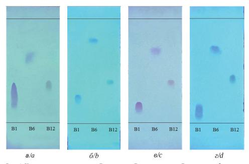
Рис. 4. Хроматограммы витаминов  $B_1$  – тиамин,  $B_6$  – пиридоксин,  $B_{12}$  – цианокобаламин в водно-органических ПФ, содержащих фосфатный буферный раствор. НФ: Сорбфил (ПП), BTCX.  $C_R = 1 \cdot 10^{-3}$  мг/мл. ПФ:  $CH_3CN - \Phi E$  (15:85). a-2; 6-3; 6-4; c-5 Fig. 4. Chromatograms of vitamins  $B_1$  – thiamine,  $B_6$  – pyridoxinum,  $B_{12}$  – cyanocobalamin.in
