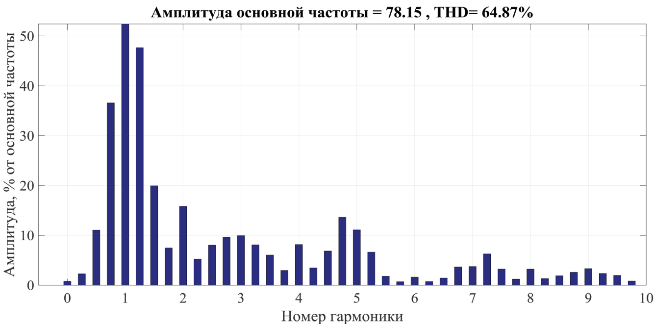
Рисунок 3. Результаты быстрого вейвлет-преобразования тока фазы
