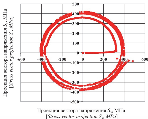
Рис. 7. Траектория проекции вектора напряжения S_1-S_3 Figure 7. The trajectory of the projection of the voltage vector S_1-S_3
