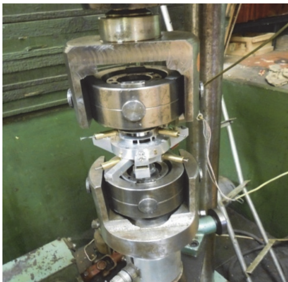
Рис. 2. Загрузочный модуль для трехпараметрического воздействия Figure 2. Loading module for three-parameter impact
