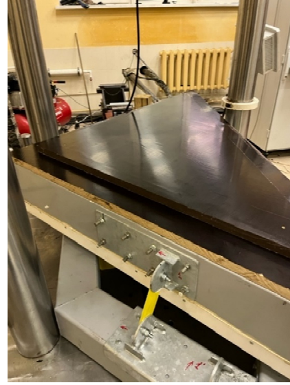
Рис. 5. Образец для испытания (элемент конструкции светопрозрачного покрытия) И с т о ч н и к: фото А.Р. Масёнене, С.В. Клюева Figure 5. Sample (element of translucent roof structure) S o u r c e: photo by A.R. Masenene, S.V. Klyuev
