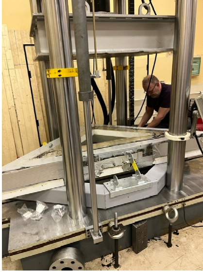
Рис. 4. Расположение образца с оснасткой на опорной плите испытательной машины И с т о ч н и к: фото А.Р. Масёнене, С.В. Клюева Figure 4. Position of the sample with equipment on the base plate of the testing machine S o u r c e: photo by A.R. Masenene, S.V. Klyuev
