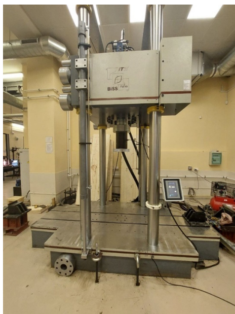
Рис. 2. Универсальная испытательная машина UT-05-2000
