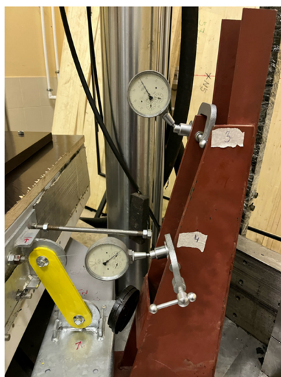
Рис. 8. Размещение прогибомеров при испытании: a — узел 1; b — узел 2; c — узел 3
