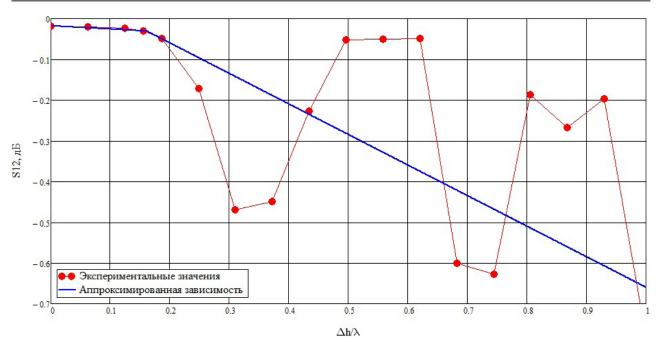
Рис. 10. Зависимость передаточной характеристики от относительной величины сдвига Fig. 10. Dependence of the transfer characteristic on the relative magnitude of the shift
