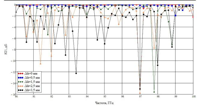
**Рис. 6.** Передаточная характеристика металлодиэлектрического волноводного тракта с нерегулярностью типа сдвиг **Fig. 6.** Transfer characteristic of a metal-dielectric waveguide path with a shift-type irregularity
