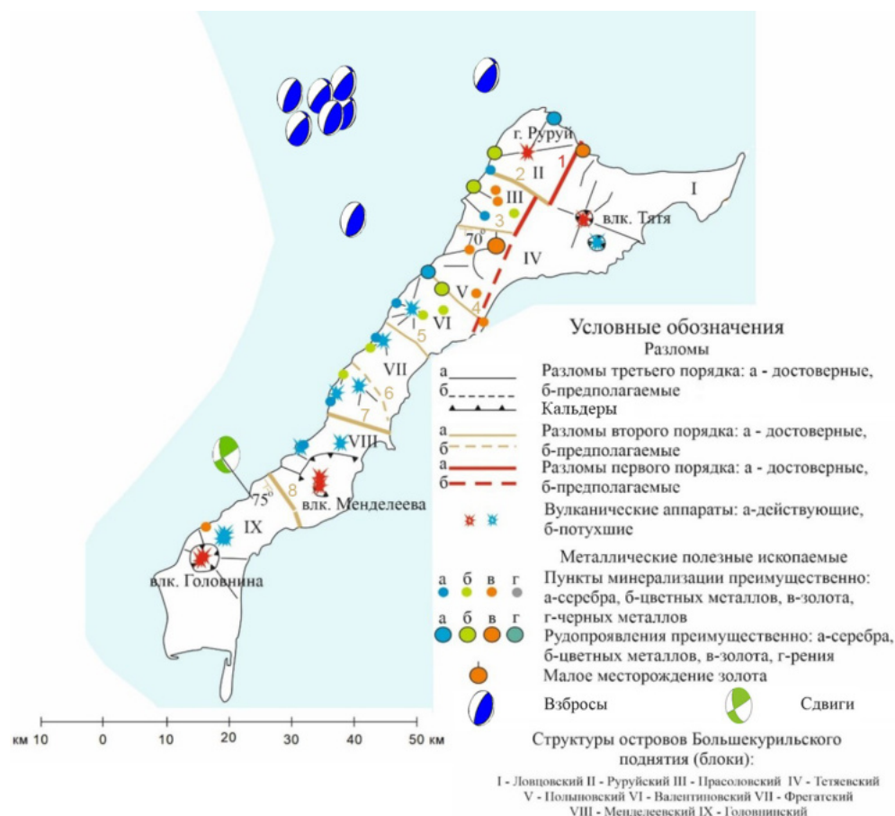
Рис. 5. Схема дизъюнктивных структур острова Кунашир с объектами размещения металлических полезных ископаемых. Разломы первого и второго порядков и их номера: 1 – Центрально-Кунаширский; 2 – Назаровский; 3 – Северянковский; 4 – Мостовской; 5 – Илюшинский; 6 – Отрадный; 7 – Южно-Курильский; 8 – Серноводский.
