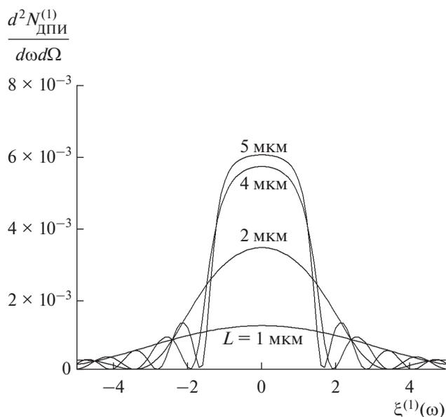
Рис. 2. Спектрально-угловые плотности ДПИ для различной толщины монокристалла при фиксированных углах наблюдения:  $\theta_{\perp} = 10$ ,  $\theta_{\parallel} = 0$ .  $\gamma = 100$ .
