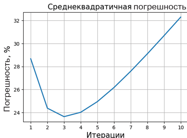
Рис. 8. Результаты эксперимента № 1. Зависимость среднеквадратичной погрешности реконструкции от номера итерации. Использовался алгоритм OSEM, 10 подгрупп
