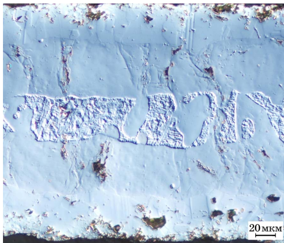
Фиг. 11. Морфоструктура поверхности шлифа нитридной керамики, синтезированной при температуре 1900 °C как пример формирования нитридной фазы из расплава твердого раствора (Zr,U)
