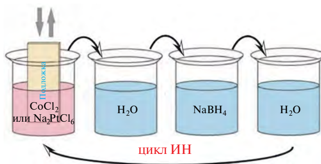
Рис. 1. Схематичное изображение последовательности обработок подложки в растворах реагентов и воде в течение 1 цикла ИН.
