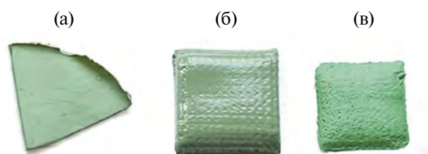
Рис. 7. Изображения композитных анодных заготовок, полученных методами литья (а), струйной печати (б) и после отжига по программе 3 (в).
