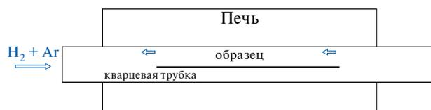
Рис. 8. Принципиальная схема печи для восстановления анодных заготовок.
