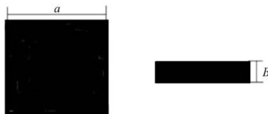
Рис. 3. Образец для измерения диэлектрической проницаемости.
