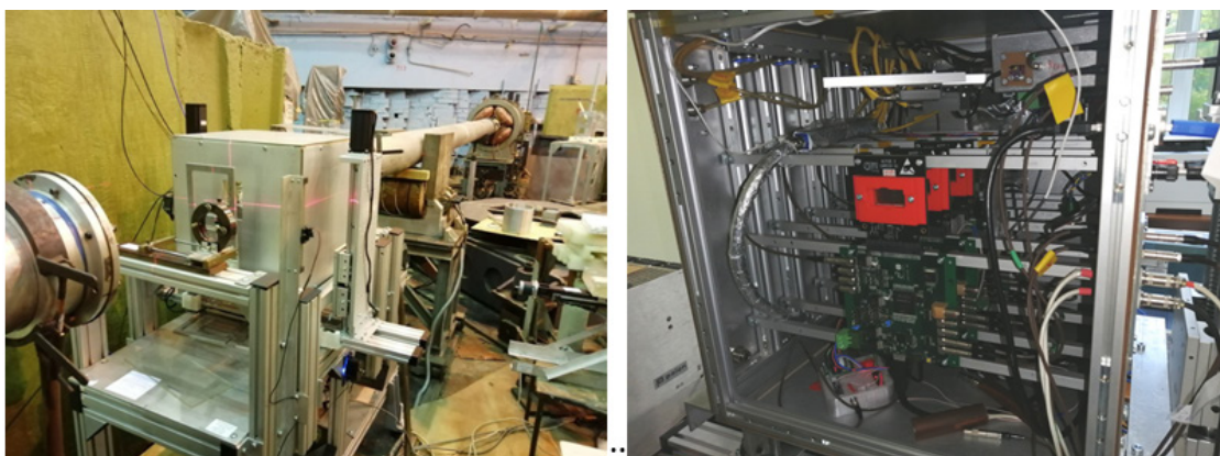
Рис. 2. Экспериментальная установка на основе телескопа пиксельных детекторов: общий вид установки на пучке протонов синхротрона СЦ-1000 НИЦ «Курчатовский институт» ПИЯФ (а); конструкционные особенности экспериментальной установки (б).
