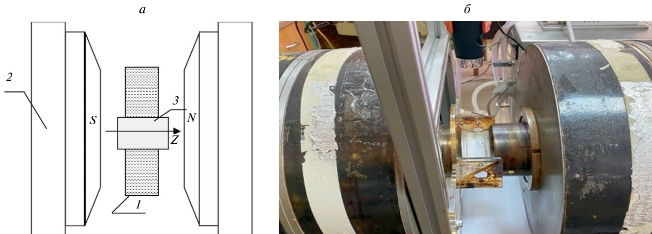
Рис. 1. Блок-схема и фотография экспериментальной установки: 1 — ячейка, 2 — электромагнит ФЛ-1, 3 — цифровой USB — микроскоп МИКМЕД 5.0.
