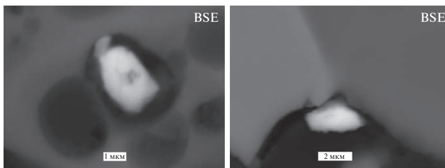
Рис. 11. Полировочный материал в порах и выколках шлифа. Отраженные электроны.
