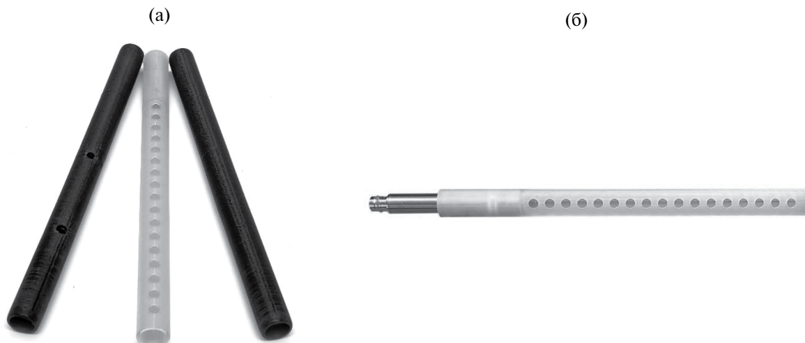
Рис. 3. (а) – Вид образцов и (б) – вид образца, надетого на микрофон.
