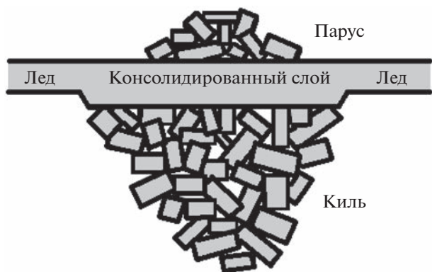
Рис. 1. Схема поперечного сечения гряды тороса.
